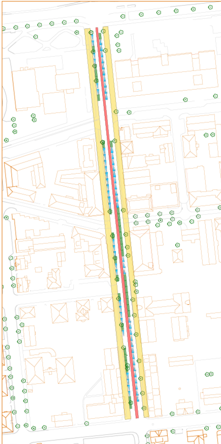
Figur 4-15 Alternativt förslag för Nygatan med genomgående cykelbana i gatumitt, gångbanor längs fasaderna, kantstensparkering och körbana för motortrafik. Gult är gångbana/trottoar, rött cykelbana, blått bilparkering, grönt kan antingen användas till plantering, cykelparkering eller bilparkering. I planillustrationen visas befintliga träd.
