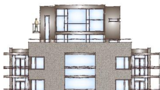
Bild 4.1.1 skala 1:500 Takvåningen är en självständig enhet i två plan som står uppe på basvolymen.
