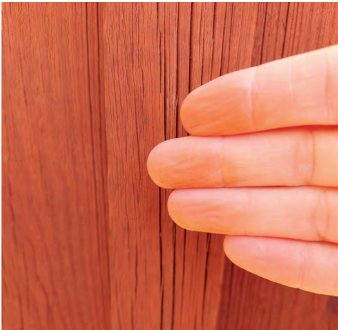
Slamfärg på fingrarna efter att ha dragit med fuktade fingrar över träytan.
